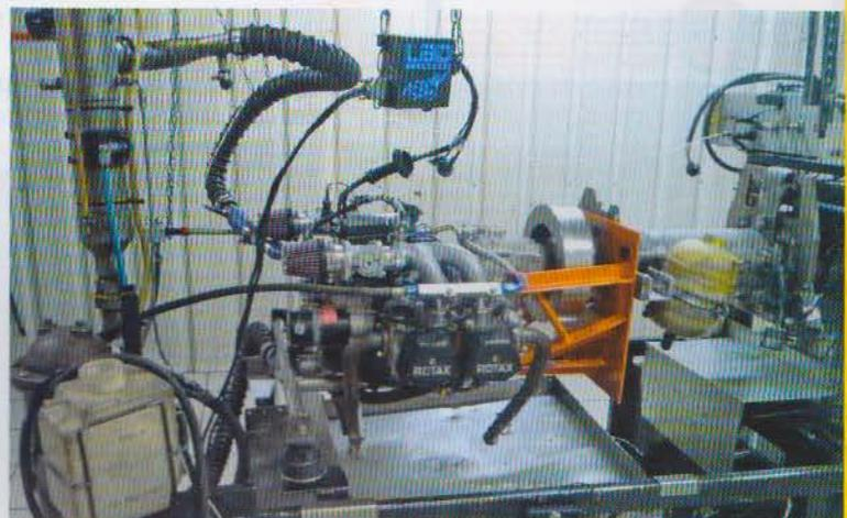
Le 912 monté sur le banc équipé des rampes d'injection.
