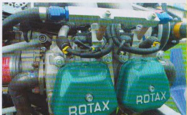
Rampe et injecteurs: notez les entretoises en matériau isolant qui empêchent l'échauffement par conduction du carburant dans les rampes.
